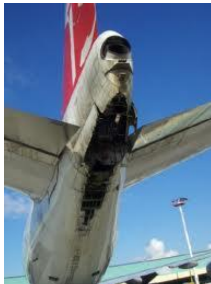
ZFW 과 takeoff weight 의 혼동으로 발생한 747 tail strike. 수리 경제성이 없어 폐기하게 된다.
