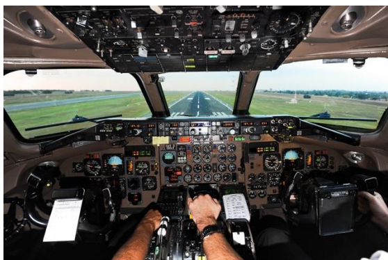
스페인의 MD-82 는 take off flap 을 setting 하지 않고 이륙 중 추락하였다.
